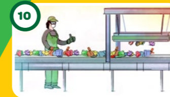
10 Os materiais ferrosos e mais pesados são selecionados pelo separador magnético.
