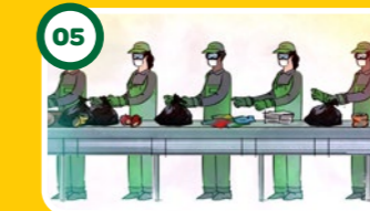
05 Os materiais são encaminhados por esteiras para a pré-seleção, onde a equipe retira os itens volumosos do processo.
