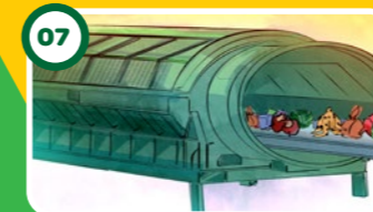
07 Após a abertura dos sacos, os resíduos entram na peneira rotativa, que possui vários furos de 8 mm de diâmetro, garantindo a separação mais eficiente dos resíduos orgânicos e recicláveis.
