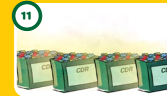
11 O material que não foi retirado em nenhuma das etapas é triturado e vira Combustível Derivado de Resíduos (CDR). A queima do lixo vira energia limpa em processos industriais.
